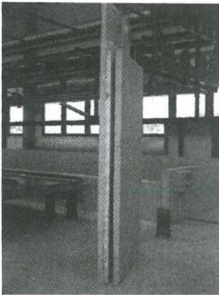
شکل ۵- قطعه‌ی قالب سرخود با عایق حرارتی میانی
